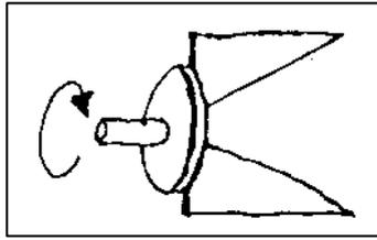
Figure 7 « Slanted blades for making cones »
