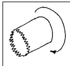
Figure 6 « Cylindrical saw »
